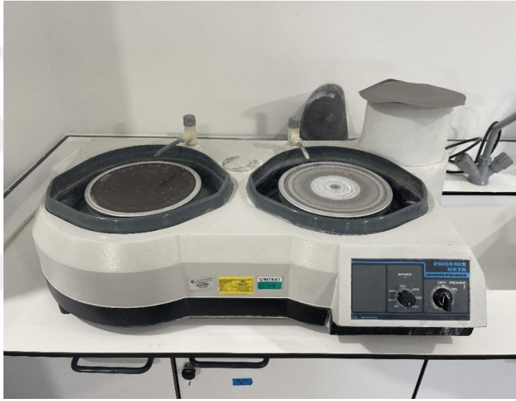
Resim 3.7: Phoenix Beta Grinder/Polisher Zımpara Cihazı (Buehler®, Almanya)
