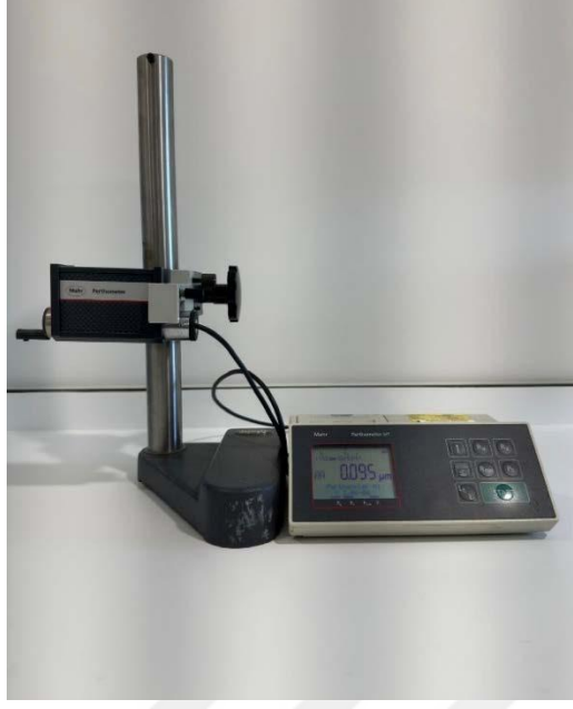
Resim 3.11: Kontakt Profilometre Cihazı (Mahr® Perthometer M1 Almanya) 3.7. YAPAY ÇÜRÜK LEZYONLARININ OLUŞTURULMASI
