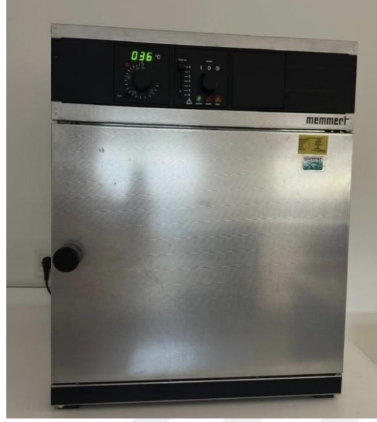
Resim 3.12: Mine örneklerinin bekletildiği 37 °C'lik etüv
