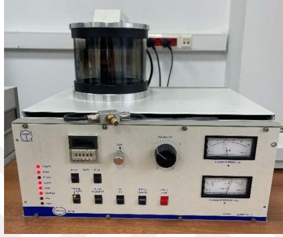
Resim 3.24: SEM analizi öncesi mine örneklerinin platin ile kaplandıđı cihaz (Quorum® SC7640 Sputter Coater)
