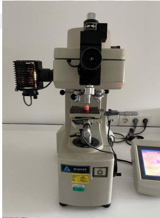
Resim 3.10: Yüzey Mikrosertlik Cihazı (Buehler®, Lake Bluff, IL, Micromet 5114D USA)
