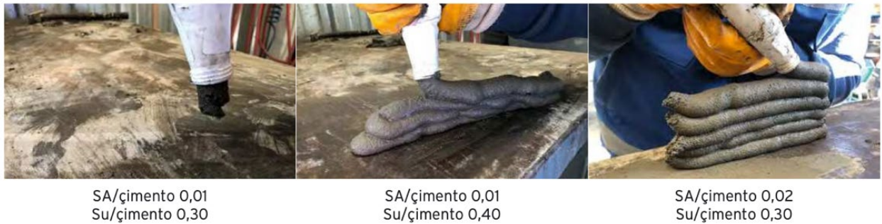
Şekil 2. Süper akışkanlaştırıcı (SA)-su/çimento oranlarının işlenebilirlik ve rijitliğe etkisi [44] (The effect of superplasticizer (SP)-water/cement ratios on workability and stiffness)
