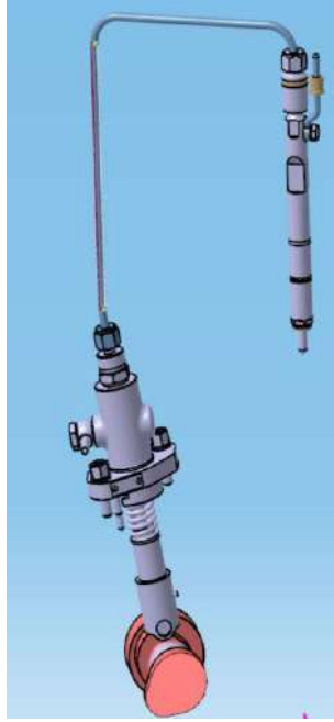
Şekil 2.Yakıt Pompası, Kam ve Enjektör Yerleşimi
