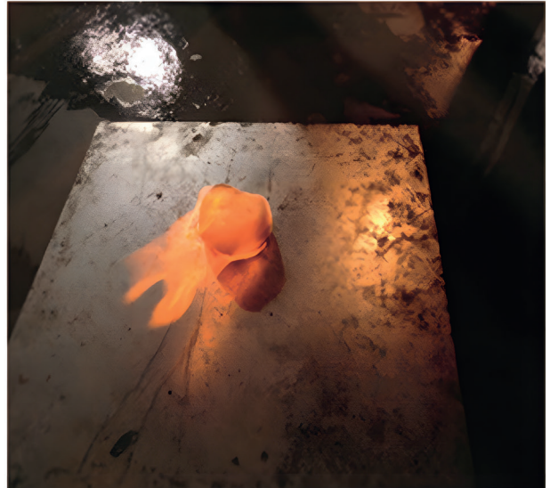
Şekil 2. Batı Karadeniz'de deniz tabanından elde edilen gaz hidratlar ve yakıldıklarındaki görüntüsü. (Şekil: TP-DEPARK Proje Raporu, 2018).
