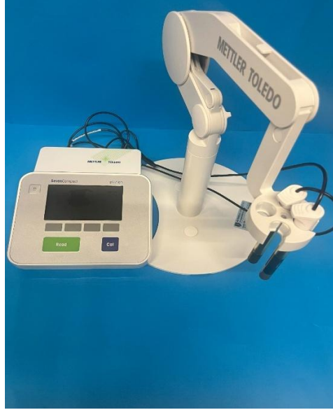
Şekil 3.5. Flor ve kalsiyum salınım ölçümlerinin yapıldığı iyonmetre cihazı (SevenCompact S220, Mettler-Toledo GmbH, Greifensee, İsviçre)
