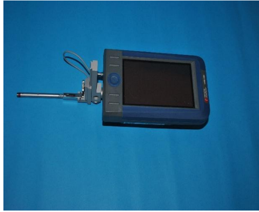
Şekil 3.4. Çalışmada kullanılan yüzey pürüzlülüğü ölçüm cihazı (Surtronic® S-100 series Taylor Hobson, Warrenville, IL, A.B.D.)
