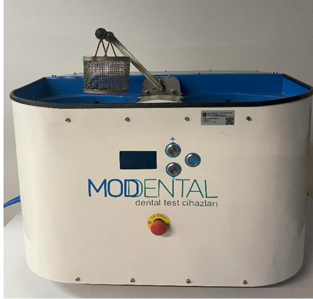
Şekil 3.6. Çalışmada kullanılan termal siklus cihazı (MTE-101, MOD Dental, Esetron Smart Robotechnologies, Ankara, Türkiye)
